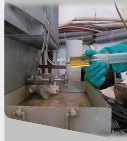
Realizamos extracción de muestras de aceite de transformadores de distribución y AT, así como análisis de laboratorio.
